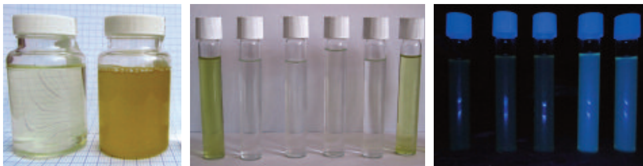
Figure 23 abc – Exemple de résultats technique Colilert en flacon (à gauche) et en tubes
